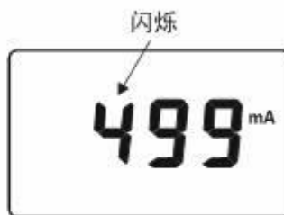
图14. 电流报警临界值设定
